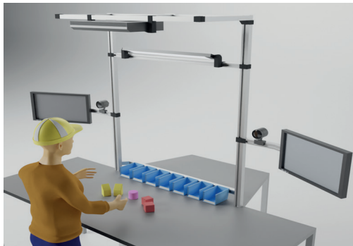
Links: Symbolischer Arbeitsplatz in AI Teach | Oben: Die Inhalte in AI Teach, von Objekterkennung über automatische Interpretation des Erkannten bis zum fertigen Ablaufplan der Montage, Bilder: BIBA GmbH
