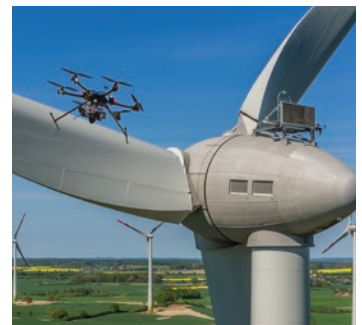
Drohnen sollen künftig die Inspektion von Rotorblättern erleichtern. (Foto: Fotolia) | UAVs are set to facilitate the inspection of rotor blades in the future. (Image: Fotolia)
