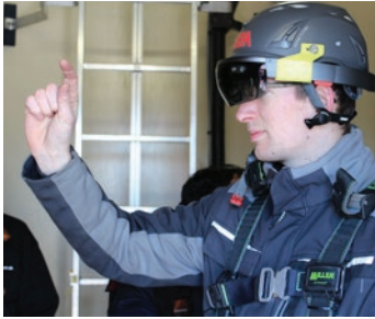
Mit Handgesten ruft sich der Techniker die gewünschten Informationen in die Blickfeldanzeige der Datenbrille. (Foto: AnyMotion) | Technicians use hand gestures to bring the information they need into the data glasses' field of view. (Image: AnyMotion)
