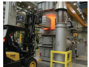
Die Herstellung von Aluminiumschmelze ist sehr energieaufwendig. Das Leichtmetall verflüssigt sich bei 660 Grad Celsius. (Foto: ZPF) | Aluminium smelting is a highly energy-intensive process. The light metal liquefies at 660 degrees Celsius. (Image: ZPF)
